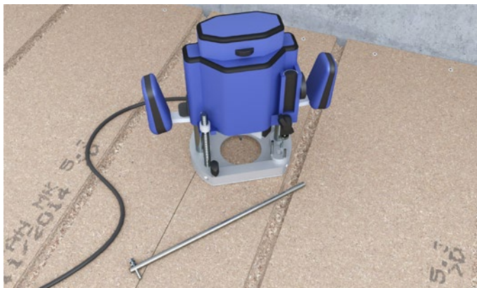
Figur 6 Novopan profiltrustning till överfräs.
