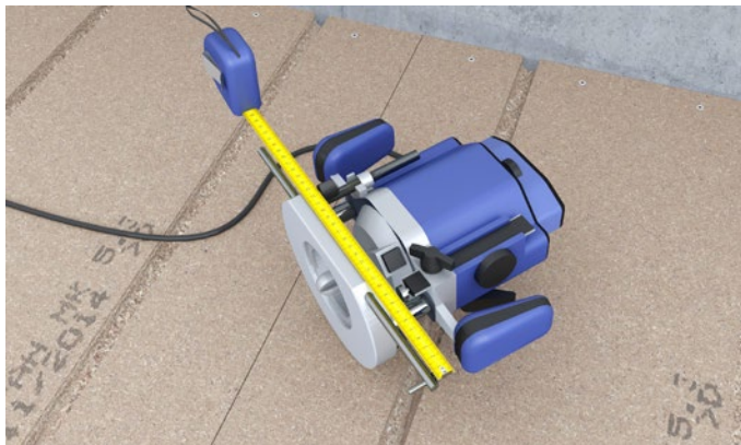
Figur 3 Fräsning utföres med profilstyrning som säkrar en korrekt och mjuk vändning. Profiltrustningen monteras i överfräsen. Avståndet c-c från penolskruv till fräsborr justeras för användning i 22 mm, 25 mm eller 38 mm golvsjivor, se tabell 1.
