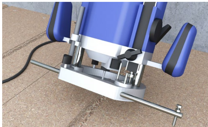
Figur 4 Fräsborr och fräsdjup väljs och justeras, se tabell 1. Penolskraven justeras eventuellt i höjd och sänks ner.
